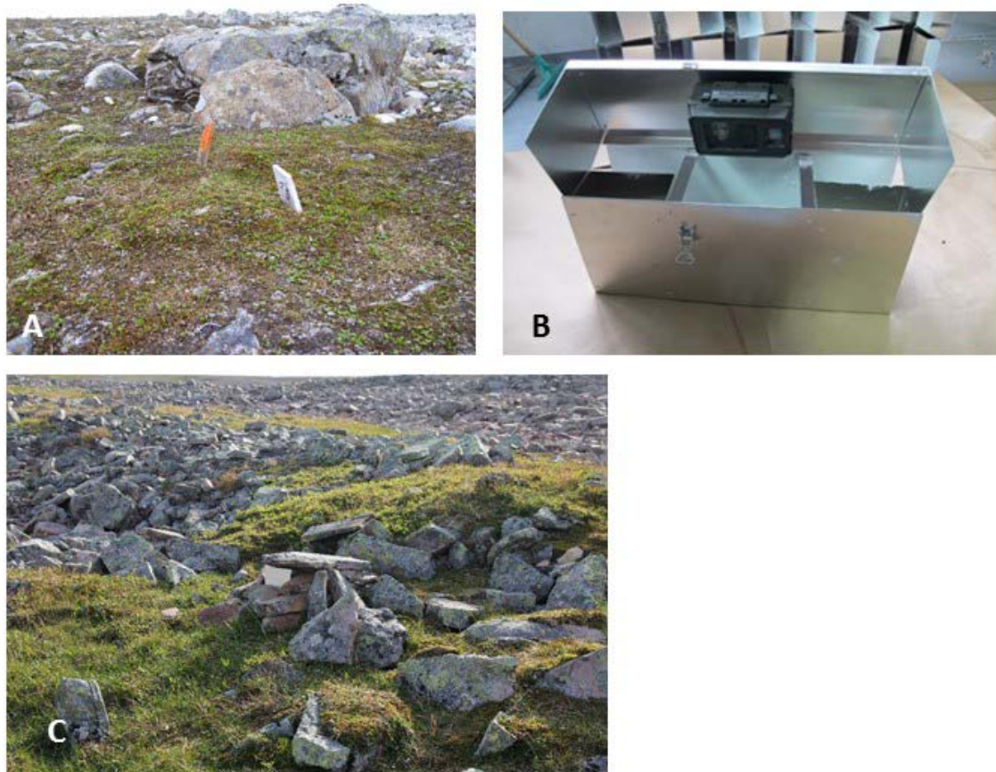
Figur 3.3.3 A) Eksisterende infrastruktur knyttet til smågnagermodul. A) merkepinner i snøleie, B) viltkamera-boks, C) viltkamera-boks plassert i felt.
