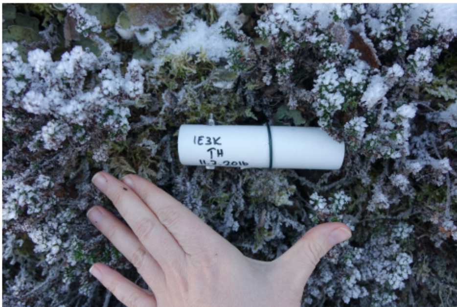
Figur 10. Eksisterende infrastruktur i klimaobservasjonsystem; en modulstasjon i form av en temperaturlogger montert på bakken.
