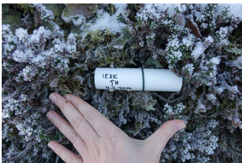
Figur 3.8.3. Eksisterende infrastruktur i klimaobservasjonssystem; en modulstasjon i form av en temperaturlogger montert på bakken.
