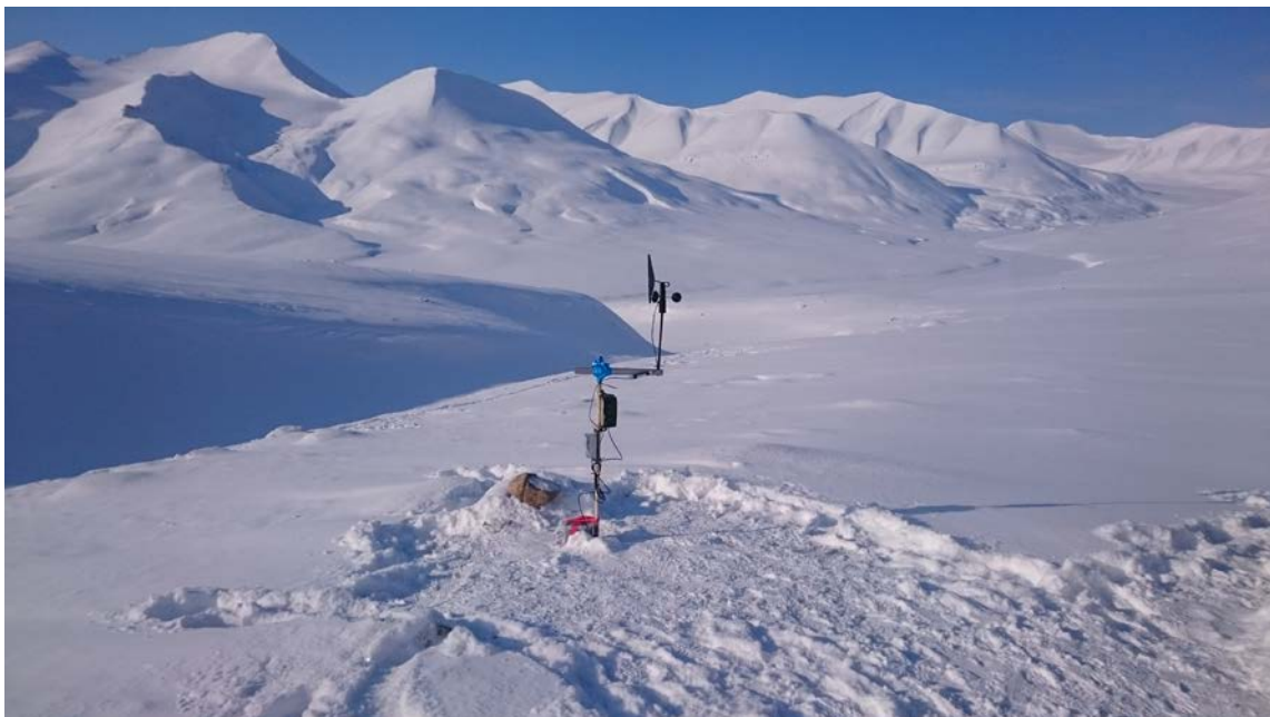
Figur 3.6.4. Ny infrastruktur i rypemodul; lyttestasjon om sommeren (øverst) og om vinteren (nederst). Vinterbildet viser, i tillegg til selve lyttestasjonen et ekstern batteri (boksen i bakken) og en vindmåler. På grunn av klimaobservasjonssystemet vil det ikke være nødvendig å montere vindmålere montert på lyttestasjonen.
