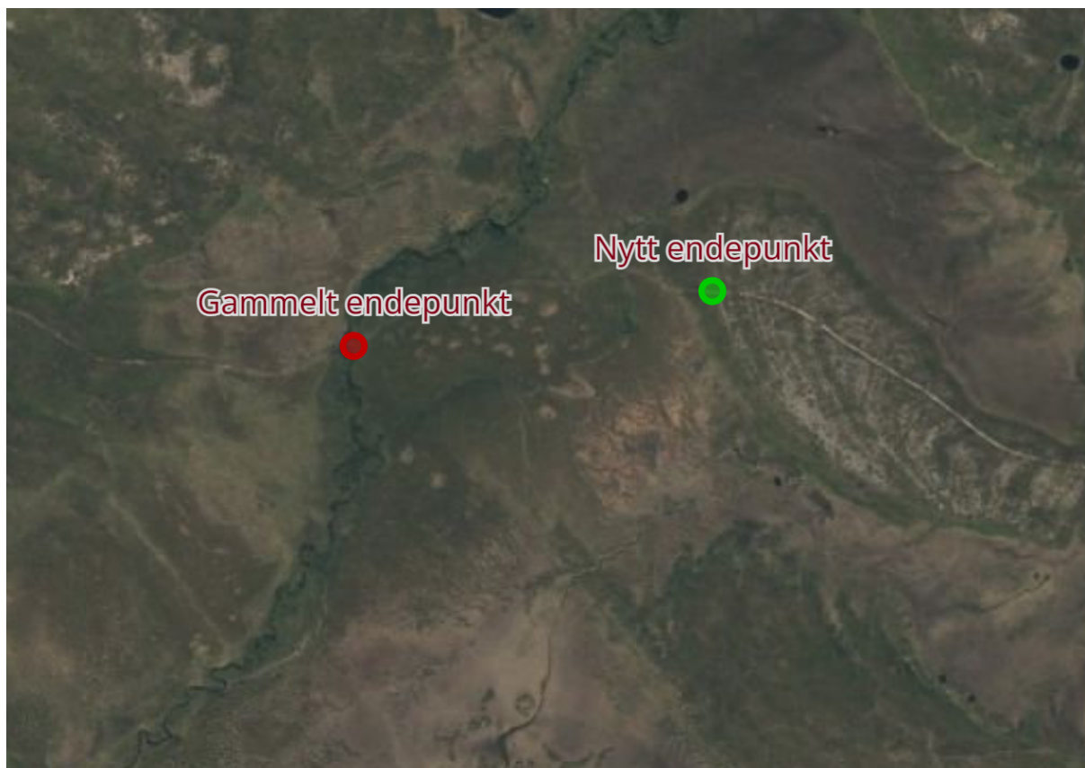
Ortofoto 1. Dalajohka – nytt endepunkt for dispensasjonstrase til Dalajoka (grønt punkt), før man kjører ut på myra før elva Dalajohka. Endepunkt flyttet for å spare kjørespor på myr med dårlig bæreevne.
