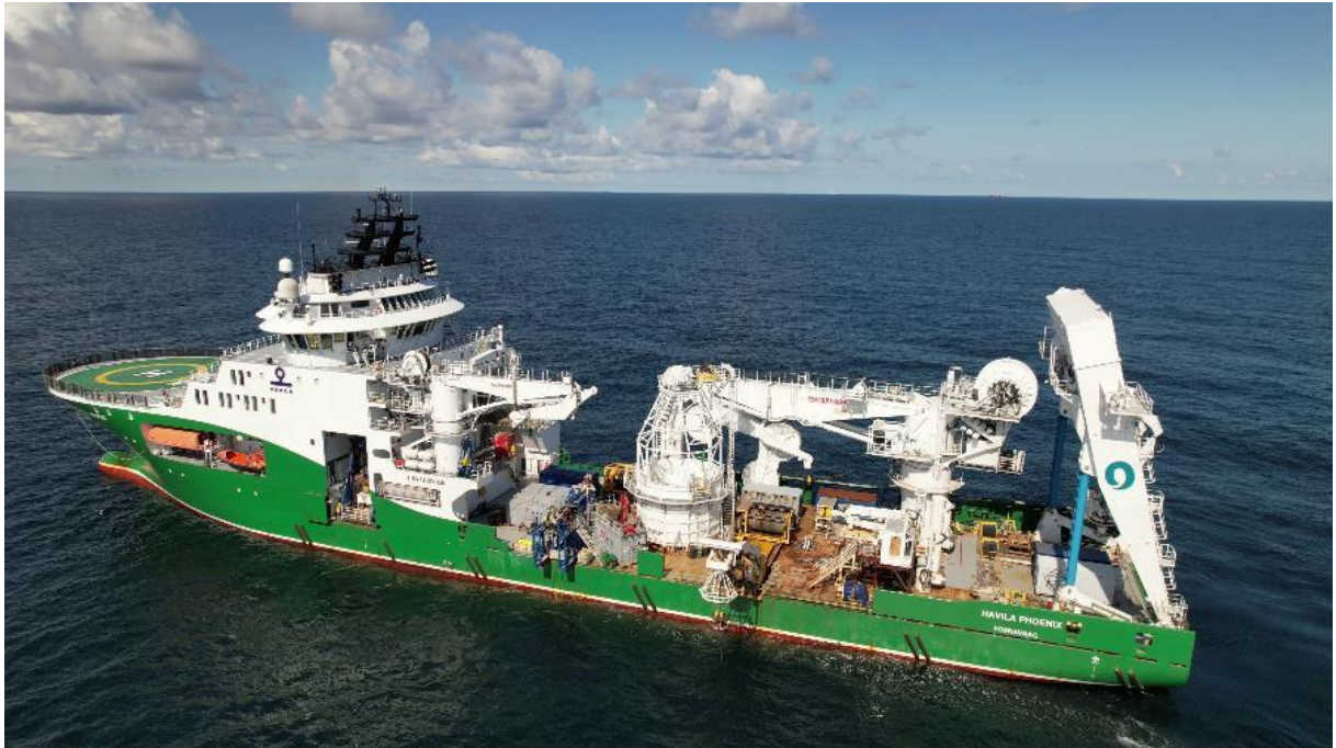
Typisk bilde av kabelleggefartøy
