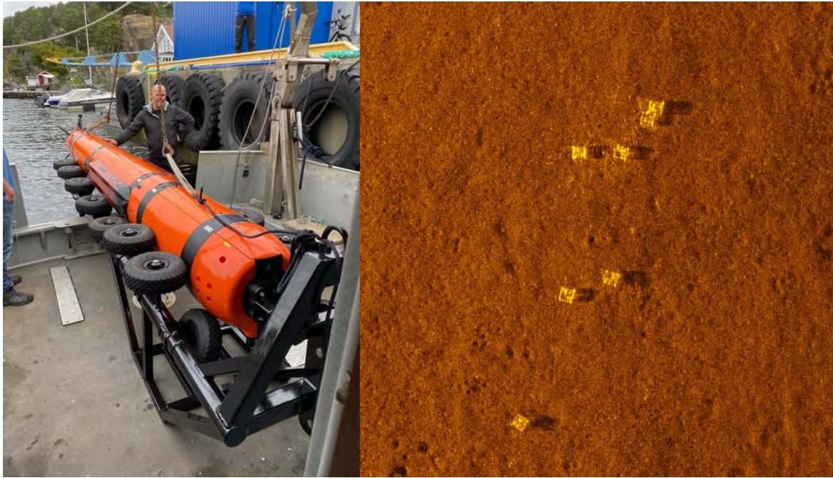
Figur 6: AUVen Munin+ rigget om bord på Tyra (venstre). Utsnitt fra kartlegging med HISAS viser en lenke med teiner på 90 meters dyp i Raet nasjonalpark(høyre). Teinene ble verifisert med ROV og berget.
