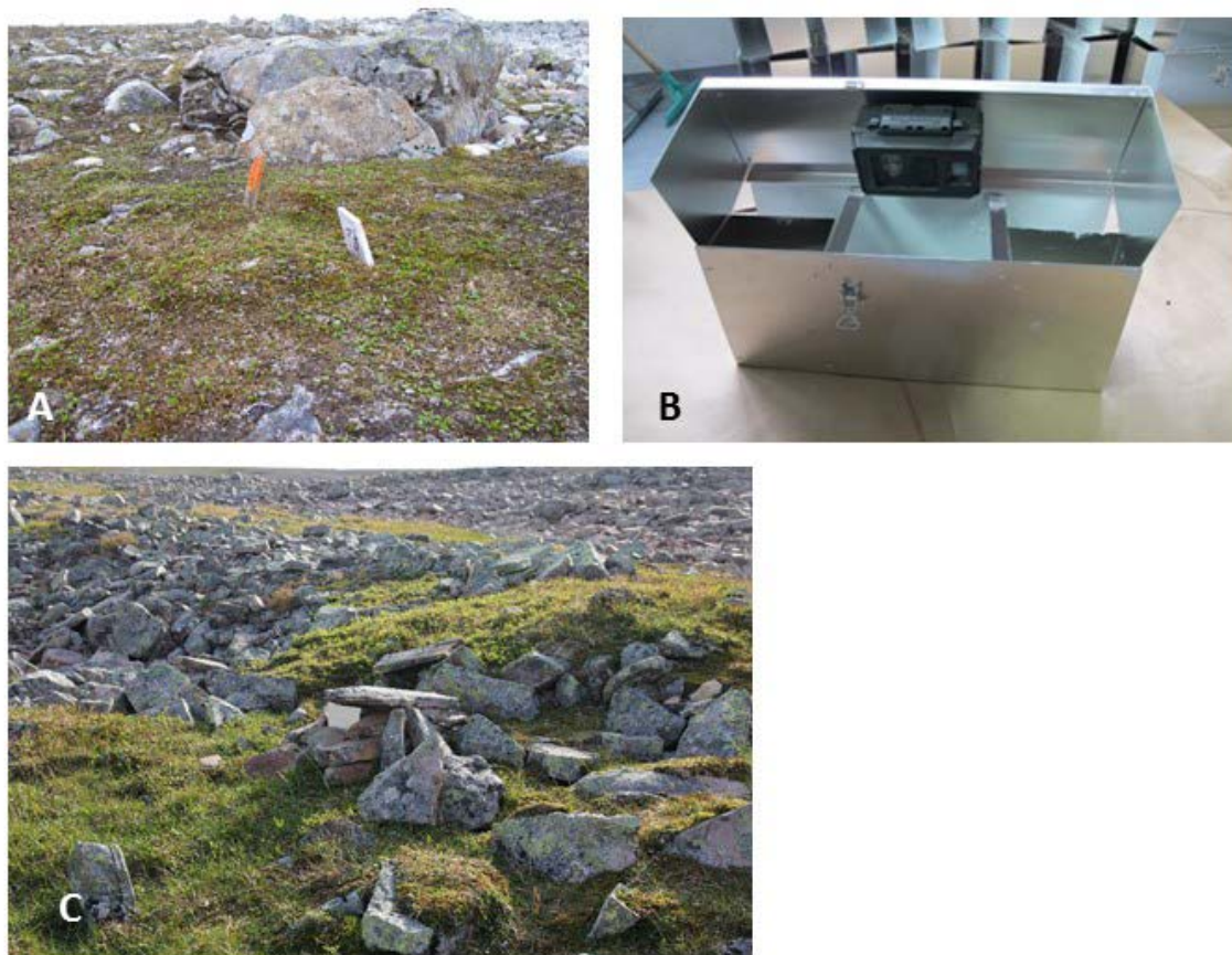
Figur 3.3.3 A) Eksisterende infrastruktur knyttet til smånagermodul. A) merkepinner i snøleie, B) viltkamera-boks, C) viltkamera-boks plassert i felt.
