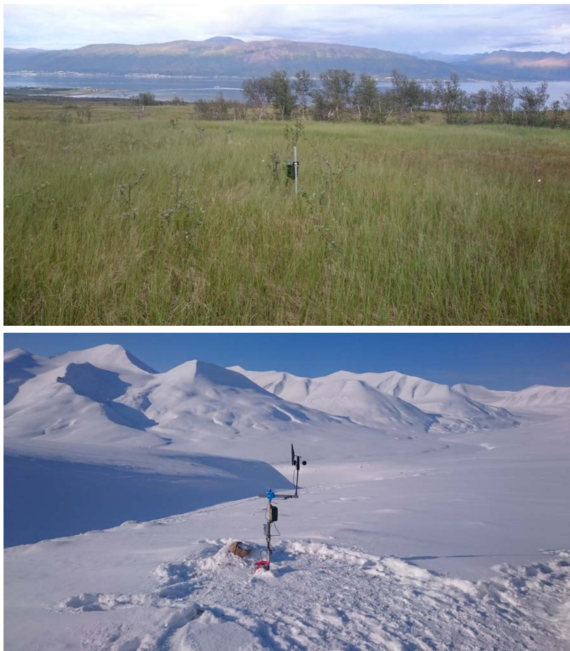
Figur 3.6.4. Ny infrastruktur i rypemodul; lyttestasjon om sommeren (øverst) og om vinteren (nederst). Vinterbilden viser, i tillegg til selve lyttestasjonen et ekstern batteri (boksen i bakken) og en vindmåler. På grunn av klimaobservasjonssystemet vil det ikke være nødvendig å montere vindmålere montert på lyttestasjonen.
