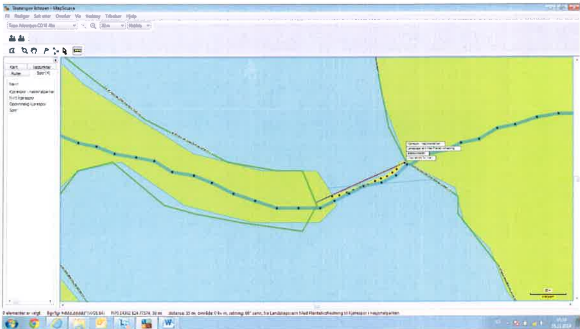
Oppmåling av del av nytt kjørespor som går mellom grensene i nasjonalparken. Oppmålingen her viser at løypen er ca. 55 m.
