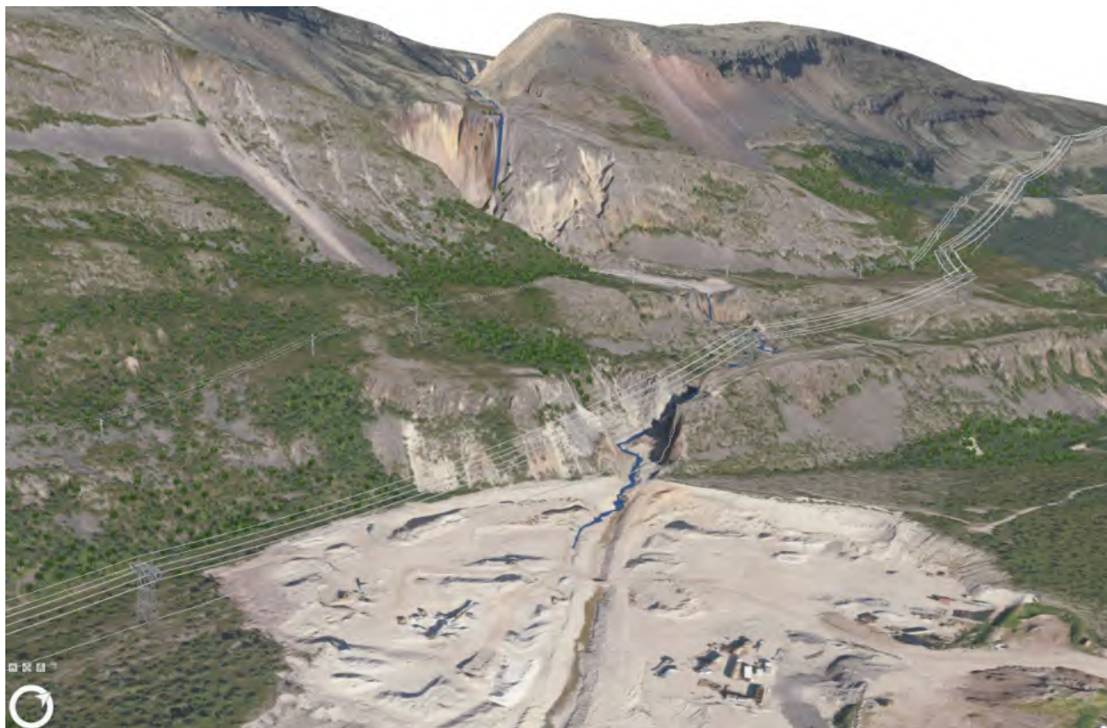
Figur 7: 3D skisse som viser føring med ny 420 kV forbi Rahppasfossen. Ledningen/mastene er flyttet lavere ned i terrenget sammenlignet med konsesjonsgitt løsning.
