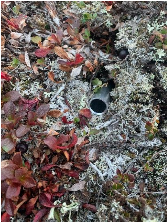
Eksempel på et av rørene som vil bli satt som fastmerke i jorda.
