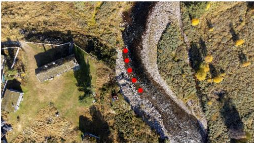
Figur 4-14 Tentativ plassering av steiner som innledende forsøk på utplassering av steiner som erosjonssikring.
