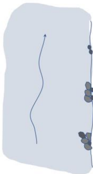
Figur 5-23 Figuren viser prinsipp for sikring med korte buner ca. 1 m ut fra bredden (svak strømvise) og utlegging av grupper av stein i kanten eller enkeltstein.
