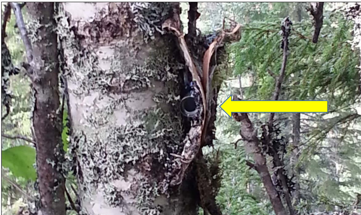
Figur 4 Ferdsesteller montert på bjørkestamme, kamuflert med never, sett rett forfra. Sirkelen er sensoren som peker vinkelrett over stien. Foto: Line C. Wold
