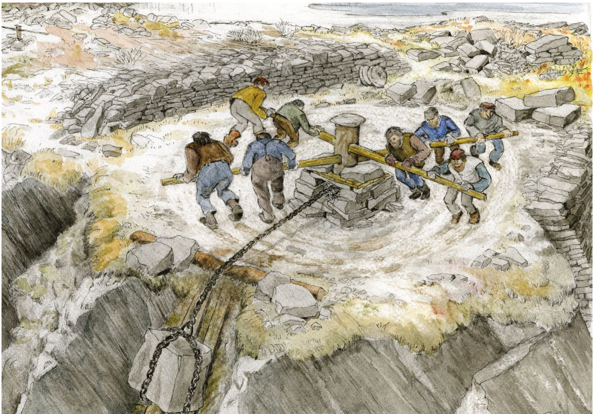
Figur 6: Illustrasjon som visualiserer gangspill, også kalt «spillgubbe», som ble brukt for å heise store steinblokker opp fra kvernsteinsbruddene. Kilde: Skarvan og Roltdalen nasjonalpark.no
