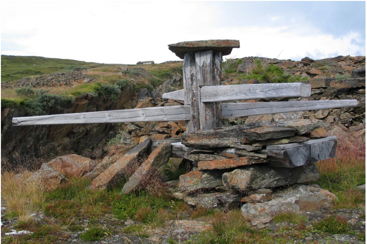
Figur 7: Foto som viser gangspill, også kalt «spillgubbe», som ble brukt for å heise store steinblokker opp fra kvernsteinsbruddene.
