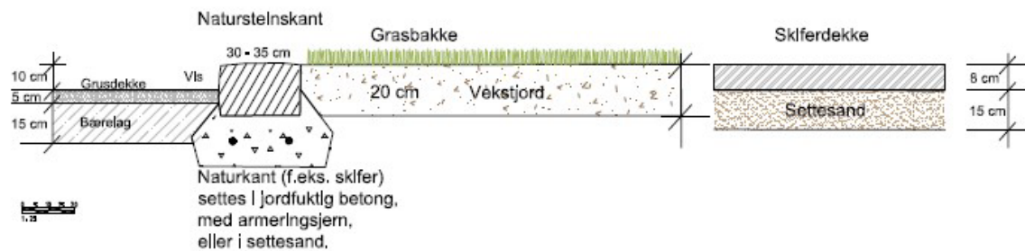
Figur 4: Detalj for tilrettelegging ved innfallsport Sildra; natursteinskant, grasbakke og skiferdekke.
