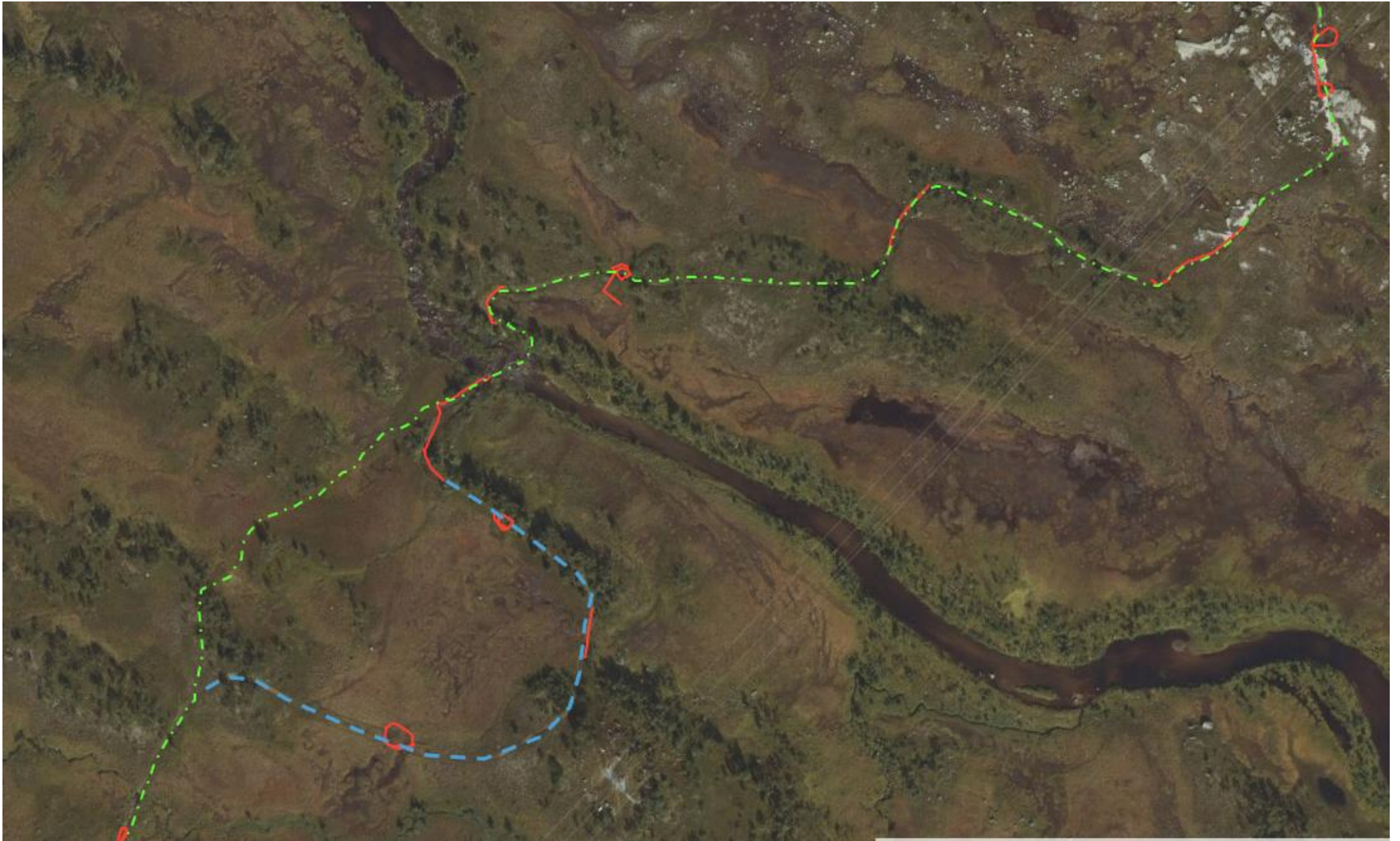
Strekning 3 – Grønn stiplet linje er kjørespor. Blå stiplet linje viser hovedtrasèen i dette området. Rød linjer er tiltakspunkt/linjer for klopplegging (steinheller).
