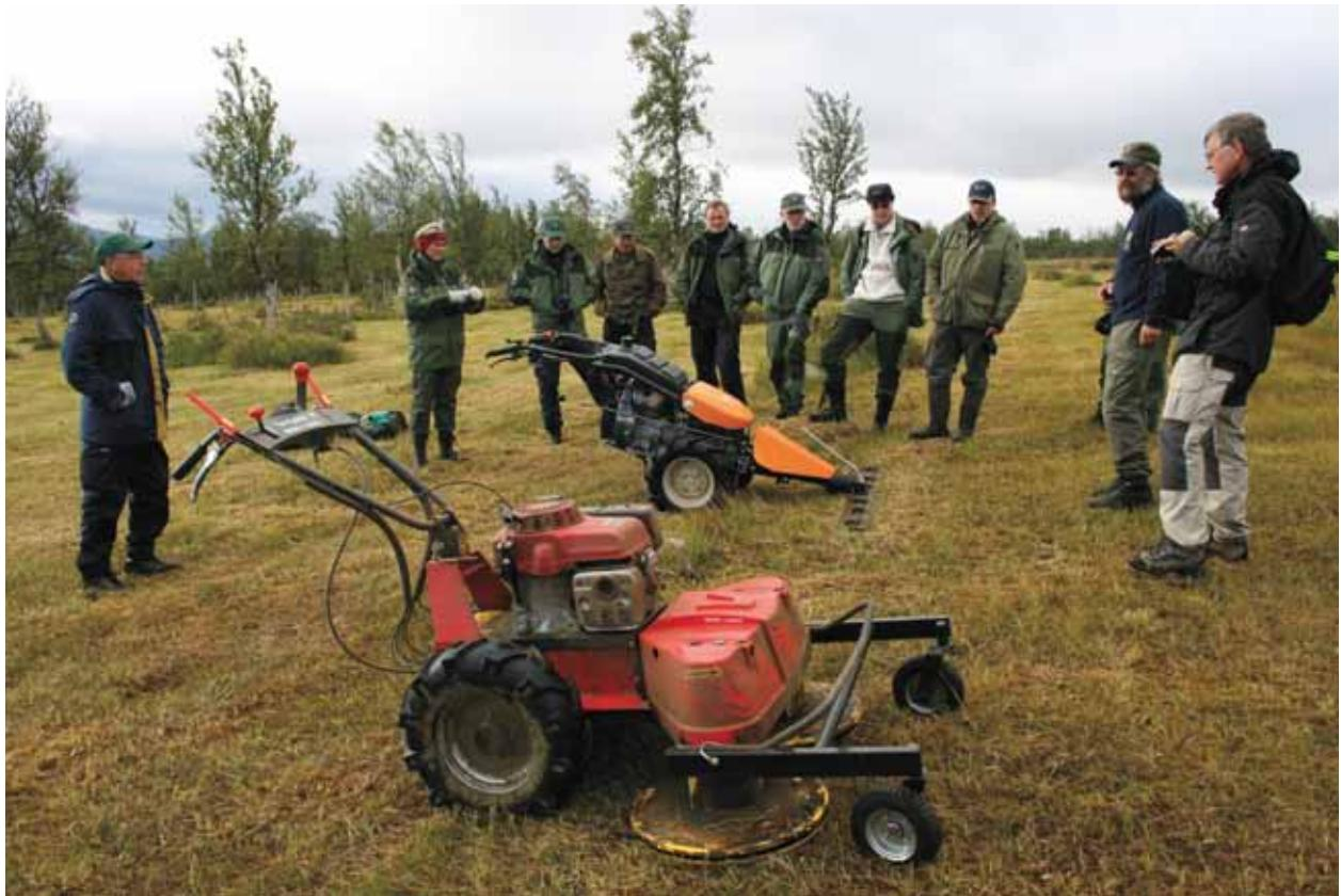
*På Sølendet har dei slått med bjelkeslåmaskin i alle år (lengst vekk i bildet), men i det siste har dei prøvd ut ei rotorslåmaskin (nærast) i tillegg. Denne kan vere billegare i drift ettersom knivane er billegare å slipe og skifte og ein erfaren slåttekar kan slå fortare med slik reiskap. Ulemper er at det blir vanskelegare å sjå ting som ligg i vegen (stein, kvist osv) foran maskina og at den har ein litt smalare arbeidsbreidd.*
