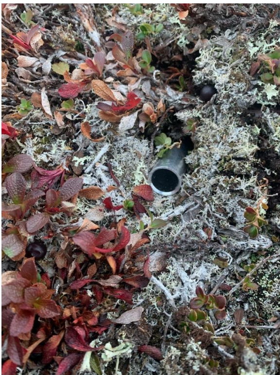
Figur 3. Nærbilde av metallrøret som slås ned i bakken i to av hjørnene til hvert punkt, og som blir stående permanent.
