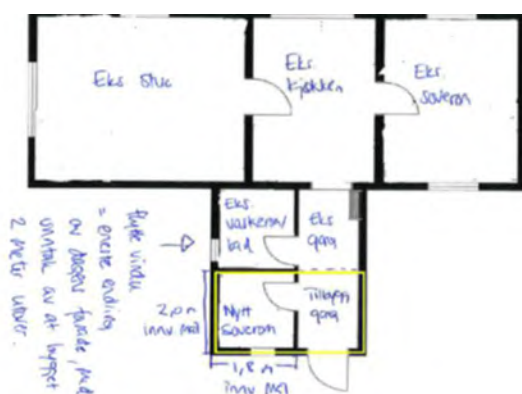
Figur 1: Viser tilbygg i gult som var omsøkt og ble oppført uten at det forelå tillatelse.
