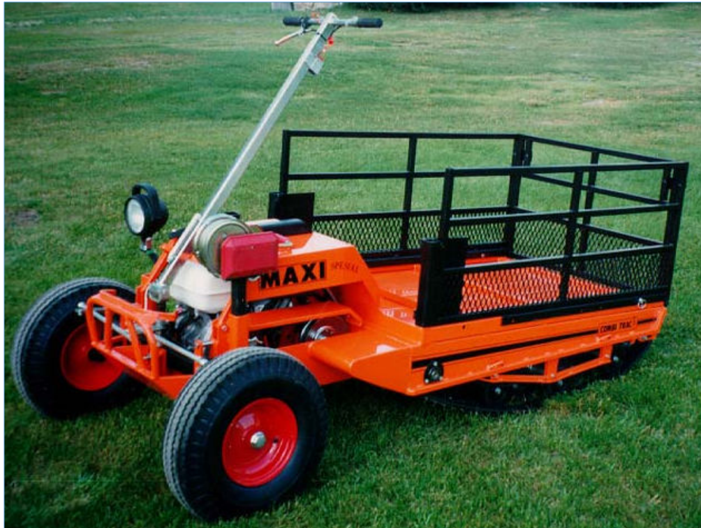
Figur 1. Elgtrekk, beltedrift, styrestag med gummi hjul (uten drift).
