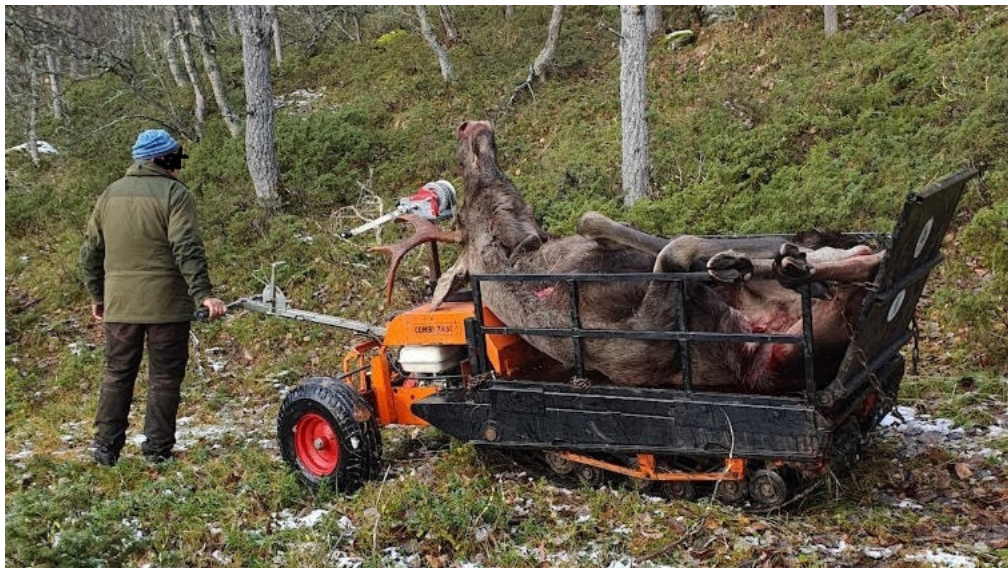
Figur 2. Elgtrekk, beltedrift, styrestag med gummi hjul (uten drift). I praktisk bruk.
