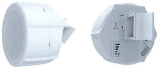
Mottakerboks som sitter øverst på antenna
