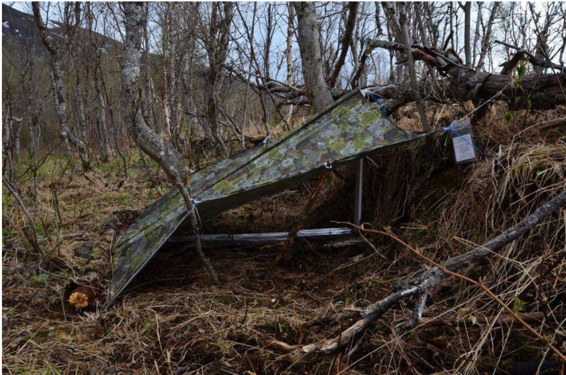
Bilde 4. Vindusfelle i flommarksskog i Dividalen Landskapsvernområde 2015. Her flyr insektene inn i en trekantet plexiglass-rute og faller ned i samlekar (brødformer i aluminium) plassert på bakkenivå. Taket i jervenduk forhindrer regnvann i prøven. (bilde av Jostein Kjærandsen, UMAK)
