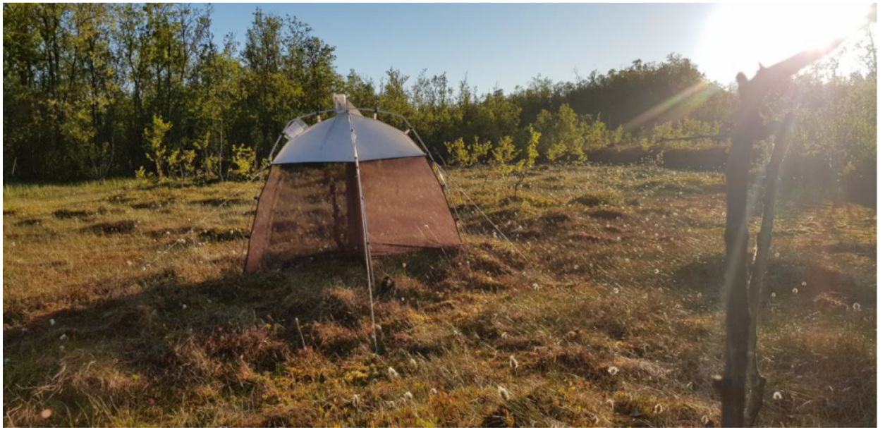
Bilde 2. SLAM-felle i Labukta (Balsfjord), 2019. Selvstående kryssfelle som fungerer etter samme prinsipp som Malaisefellene.
