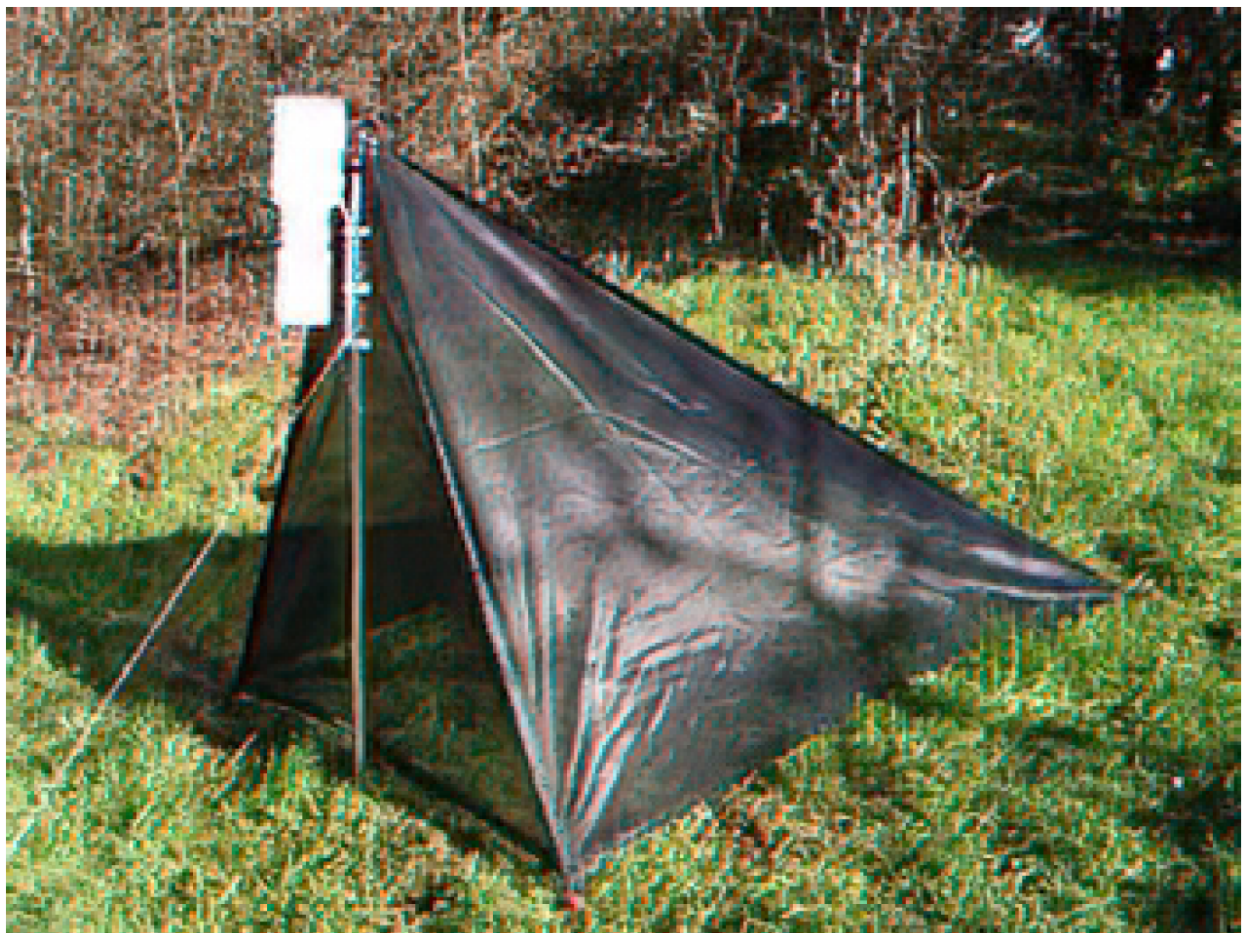
Bilde 3. Klekkefeller. Fellen fungerer etter samme prinsipp som Malaisefellene. (bilde fra internet, https://www.watdon.co.uk/acatalog/insect-traps.html )
