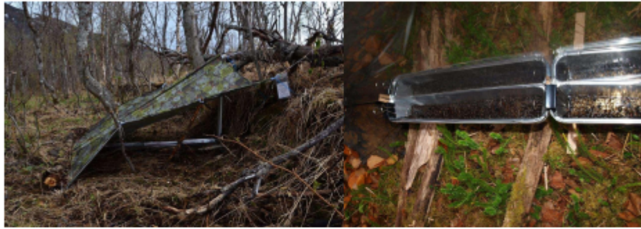
Bilde 4. Vindusfelle i flommarksskog i Dividalen Landskapsvernområde (2015, bilde av Jostein Kjærandsen, UMAK) og vindusfellefangsten med tusenvis av soppmugg etter to måneder i Reisa nasjonalpark. Her flyr insektene inn i en trekantet plexiglass-rute og faller ned i samlekar (brødformer i aluminium) plassert på bakkenivå. Taket i jervenduk forhindrer regnvann i prøven.
