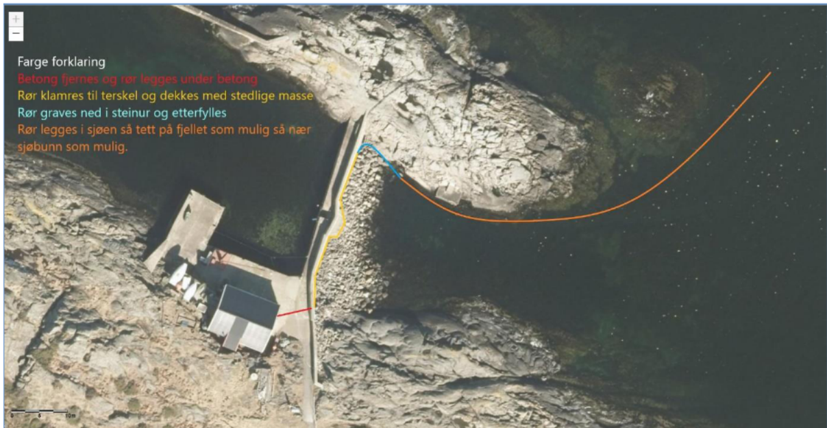
Bilde 3. Anbefalt trase etter befaring gjennomført av Agder-Dykk. Blå og gul linje vil kunne legges ned i steinfylling. Rød strek (pil) angir anbefalt ny gjennomføring fra utside av molo til sjøbod.
