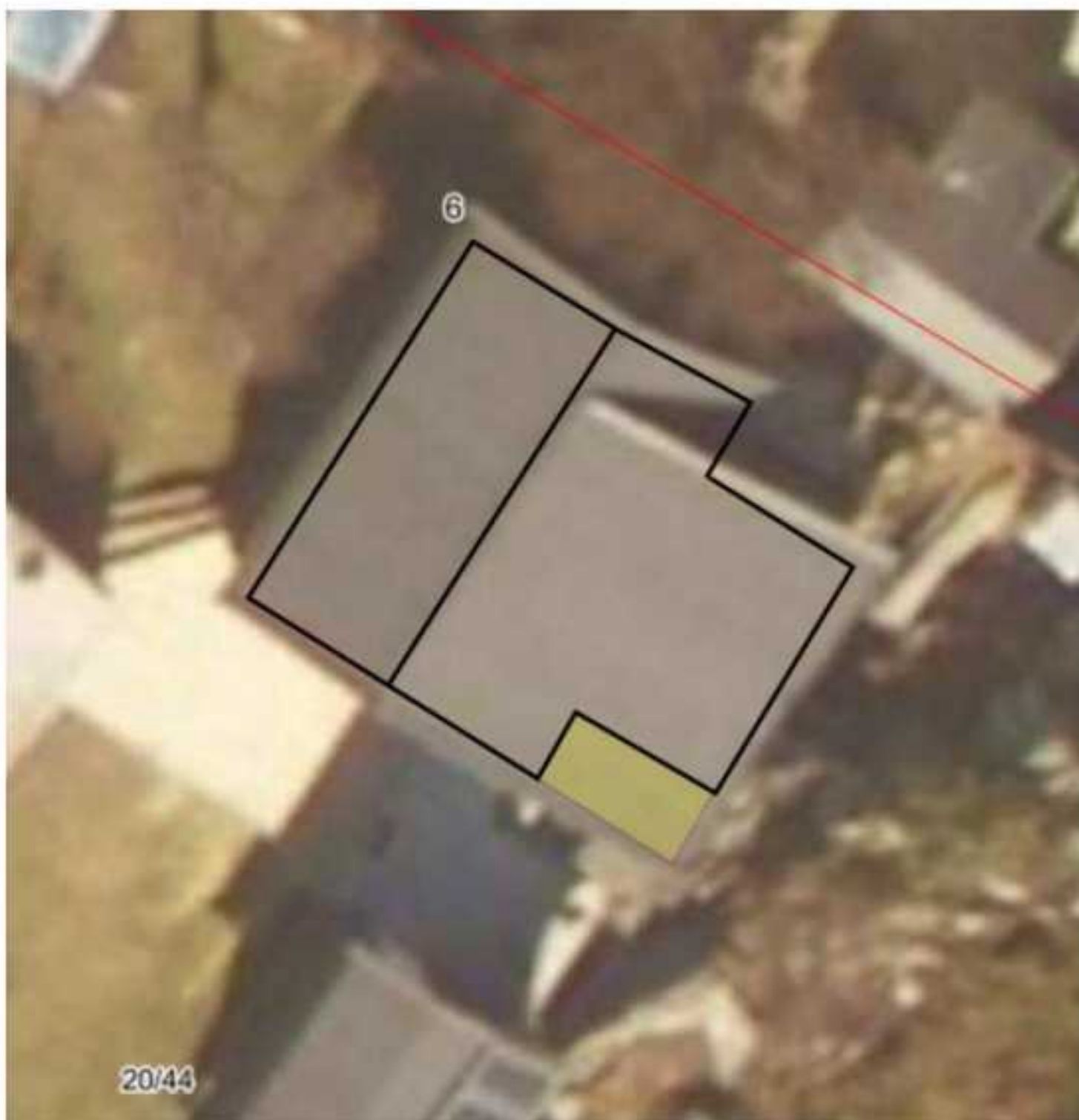
Bilde 4_ Gult viser hva som er bygget over tillatelse
