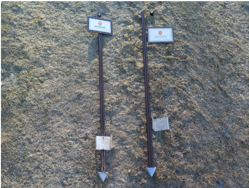
Foto: Aluminiumstang med spyd, stabilisator og hette.
