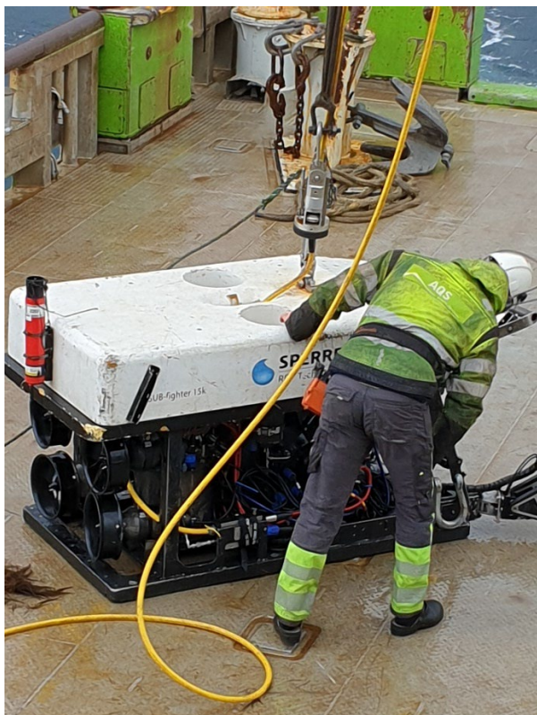
Figur 2: Sperre Subfighter 15k ROV på dekk. Høyre bilde: Truster tilstoppet av drivende kjerringhår.
