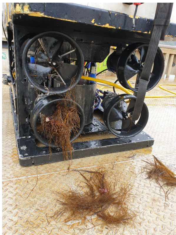
Figur 2: Sperre Subfighter 15k ROV på dekk. Høyre bilde: Truster tilstoppet av drivende kjerringhår.
