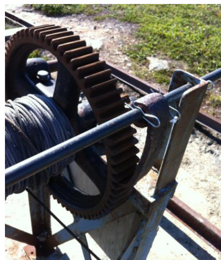
Foto til venstre viser ødelagt bremsemekanisme. Til høyre alt klart til bruk etter reparasjon. Foto: Sverre Erik Pedersen
