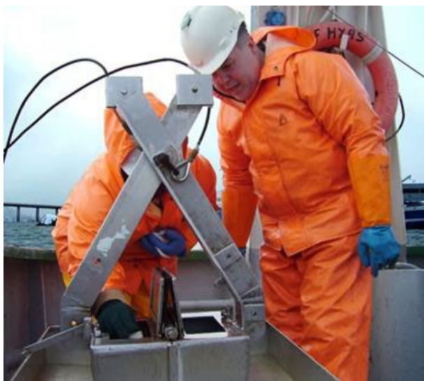
Figur 4 Van Veen grabben dekker 0,1 kvadratmeter av sjøbunnen. Bildet viser innsamling av sediment gjennom grabbens inspeksjonsluke.
