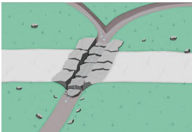
Figur 16. Vannrenne med botnstein som låser sidesteinene inn i stien. Over er det laget et Y-løp som leder vannet over stien inn i vannrenna. Illustrasjon: Miljødirektoratet
