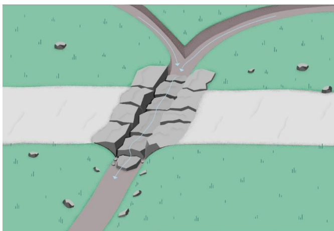
Figur 14. Vannrenne med botnstein som låser sidesteinene inn i stien. Over er det laget et Y-løp som leder vannet over stien inn i vannrenna. Illustrasjon: Miljødirektoratet
