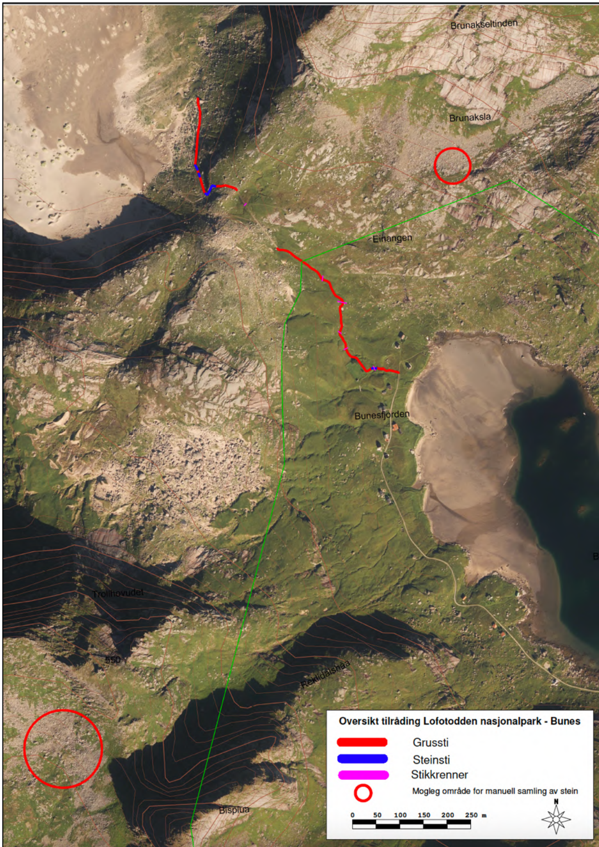
Figur 2 Foreslåtte tiltak knyttet til ferdsselsåren på Bunesanden (Kvalshaug, epost 24.01.22) inkluderer grussti, steinsti, stikkrenner og foreslåtte områder for manuell samling av stein. Uttaket av stein i sørvest er ikke en del av utredningsområdet som befares, men omtales og vurderes basert på eksisterende informasjon.
