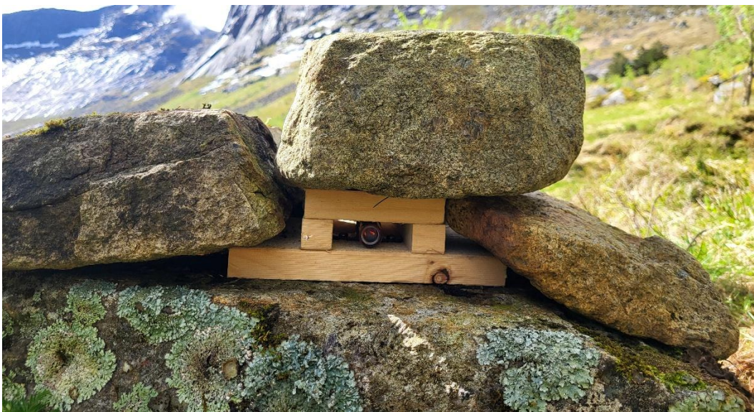
Figur 4. Ferdselsteller skjult i en varde i Kjerkfjorden. Telleren registrerer ferdsel til og fra Horseid.
