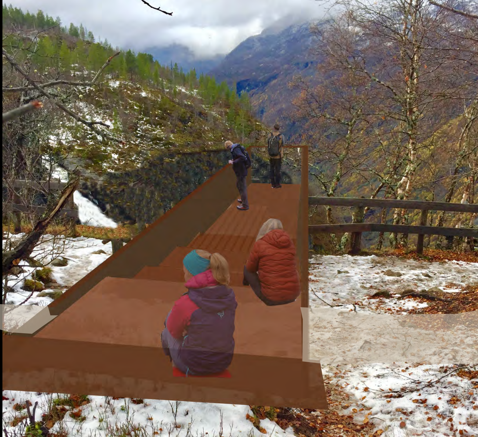
C: TRAPPA DEKKE MED BÆRING I REKKVERK
