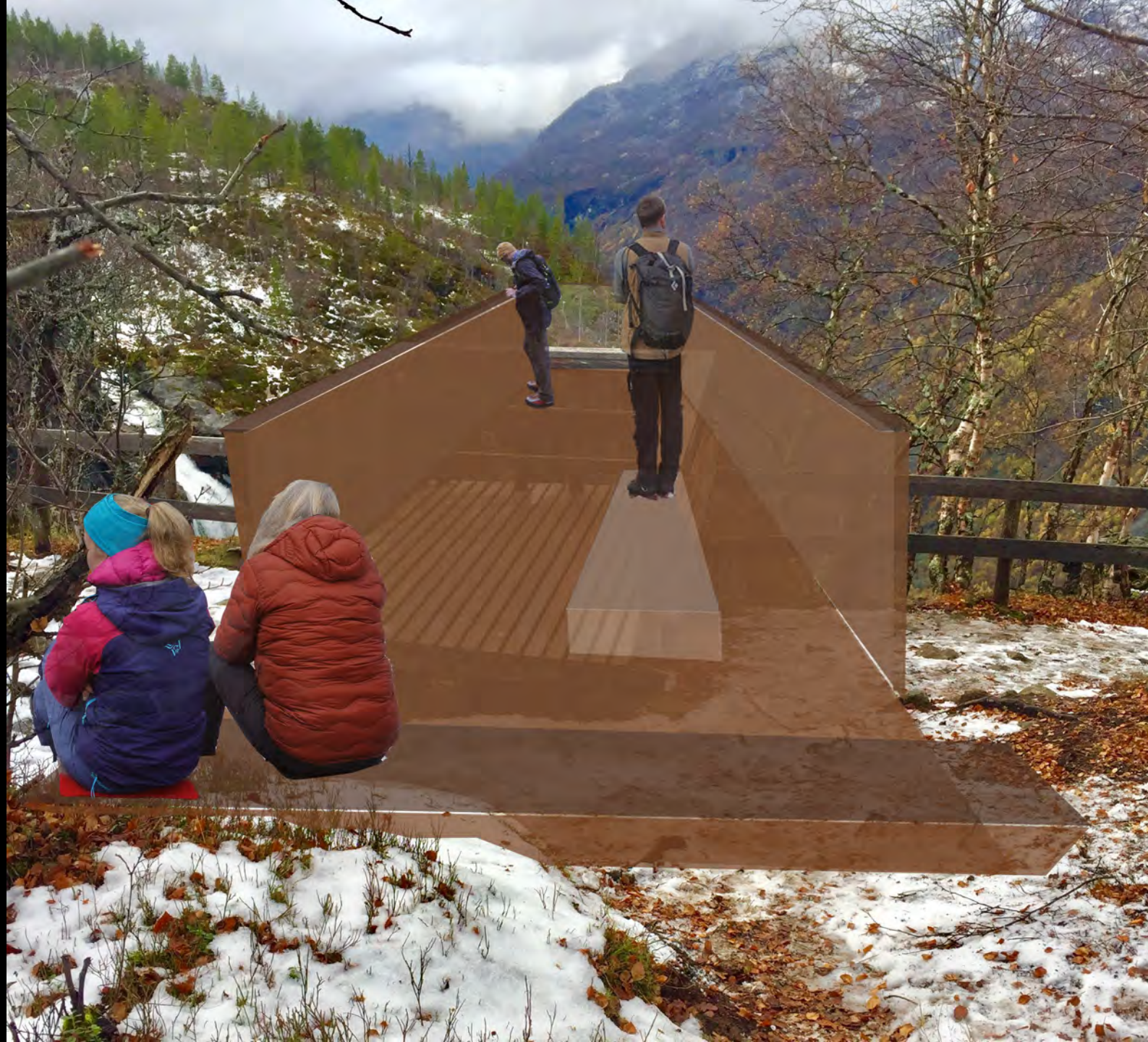
B: RETT DEKKE MED BÆRING I REKKVERK
