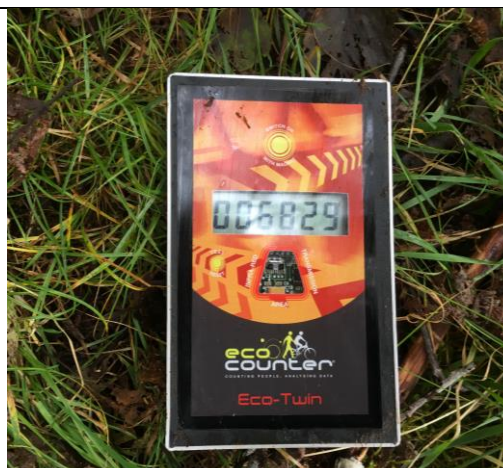
Dataeininga av ferdselsteljarane har eitt batteri som kan vare i 10 år
