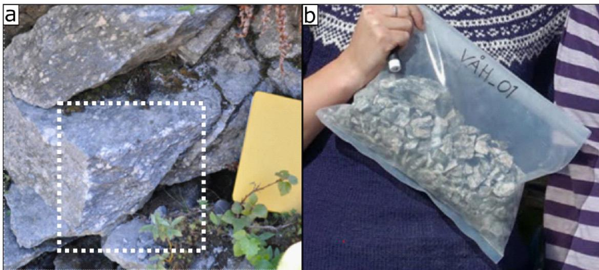
**Fig. 3a)** Veiskjæring/blotning etter at en prøve er tatt for termokronologi. Inngrepet er knapt synlig og tilsvarer en naturlig erosjons/forvitningsprosess. **b)** Typisk termokronologi-prøve: ca 2-3 kg Stein blir tatt, i dette tilfellet ble prøven videre knust til ca. 1cm x 1cm biter.
