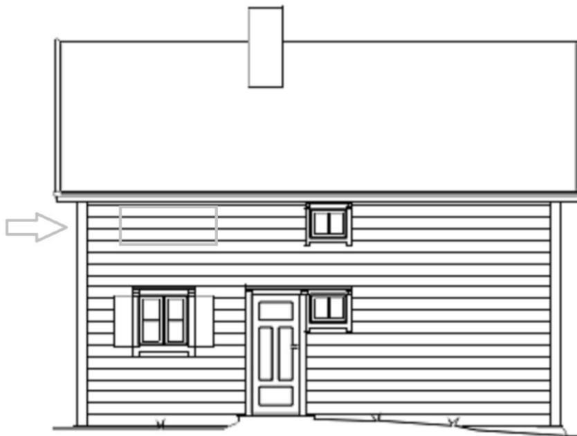
Figur 1. Fasadeteikning med plassering av solcellepanel på sørvestvegg.
