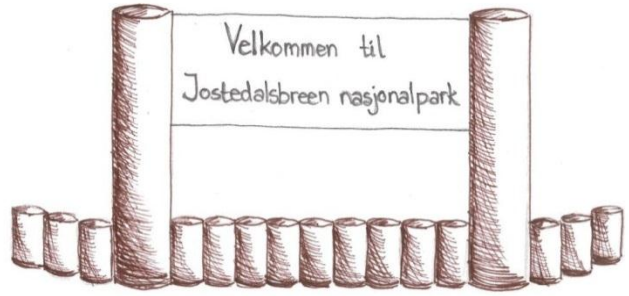
Figur 62 Informasjonskilt utformet med stående tømmerstokker.
