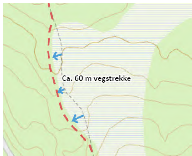
Figur 3: Vegen skal omlegges noe bort fra myrkanten.
