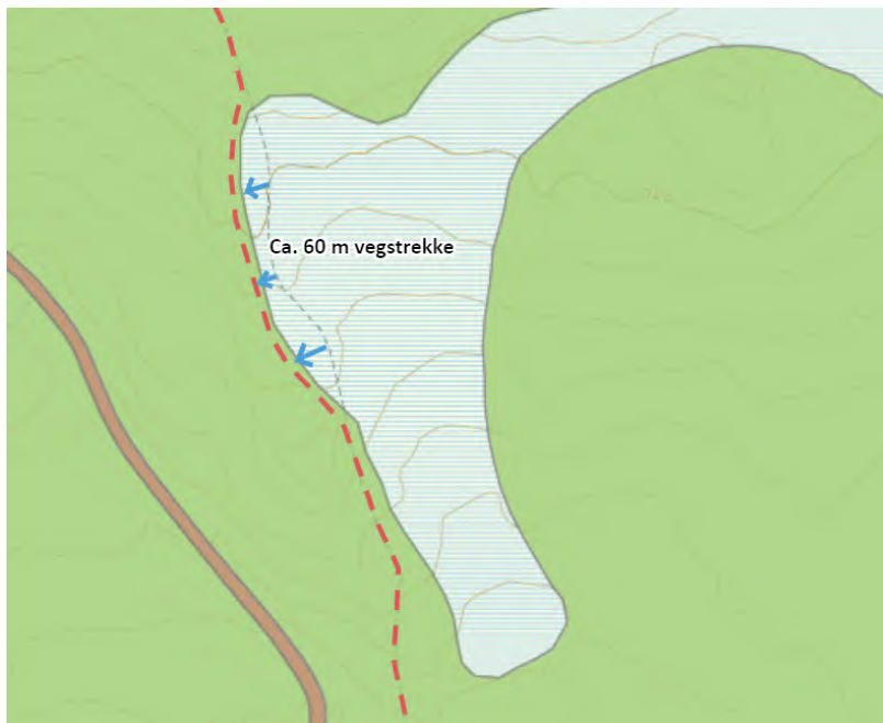
Figur 1: Omlegging av landbruksveg 2-3 meter vekk fra bløtt myrparti (ca. 60 meter vegstrekke).
