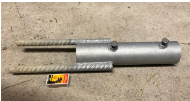
Figur 3: Fjellfundament for kamerarigg
