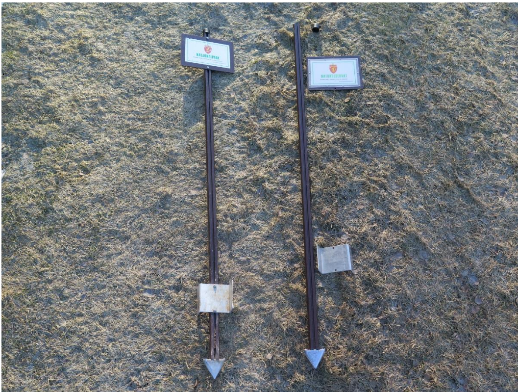
Foto: Aluminiumstang med spyd, stabilisator og hette.
