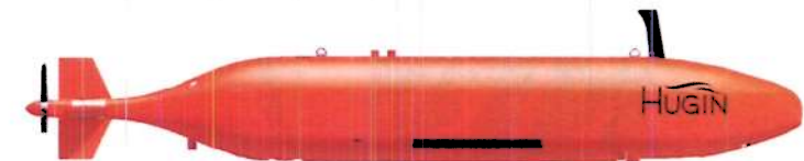
Kongsberg's «Hugin» AUV undervannsfarkost AUV = Autonomous Underwater Vehicle
