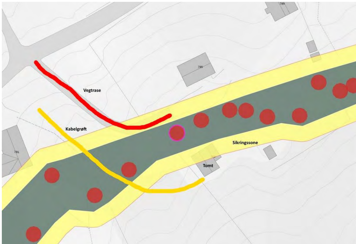
Kart 5: Fangstanlegg, sikringssone, vegtrasé og kabelgrøft
