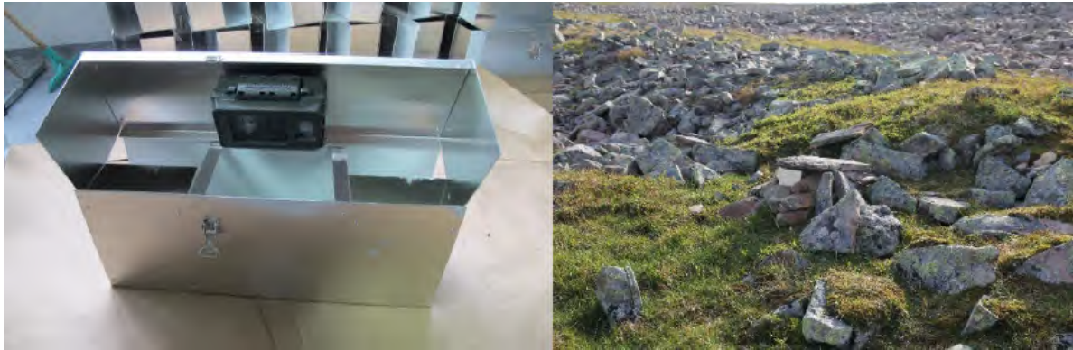
Figur 1: Til venstre kamerafeller med lokket åpent slik at man kan se kamera som er festet til taket. Målene på fella er 50cm x 17cm x 23cm. Til Høyre er kamerafella plassert ut i felt (fra Varangerhalvøya nasjonalpark), hvor steiner er plassert rundt den slik at den står stødig og ikke fylles av snø
