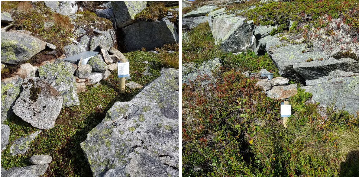
Figur 2: Kamerafeller plassert ut ved Aursjøen. Målene på fella er 50 cm x 17 cm x 23 cm. Vår erfaring er at skiltene som ses på disse bildene er det mest synlige. I den nasjonale overvåkingen vil disse erstattes med værbestandige klistremerker rett på lokket til kamerafella.
