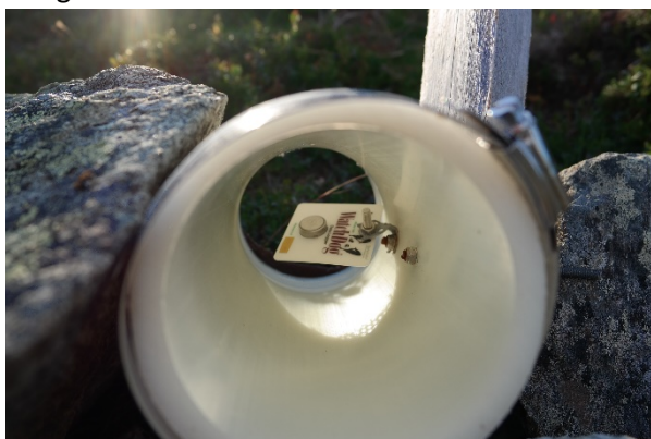
Registreringsenheten består av et lite plastkort påmontert batteri som registrerer temperatur ved faste tidspunkt. Foto: Tore Tødås
