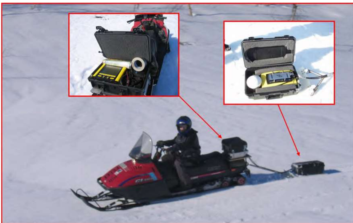
Figur 3 Snøradar: Styringsenhet på snøscooter og antenna bak.
