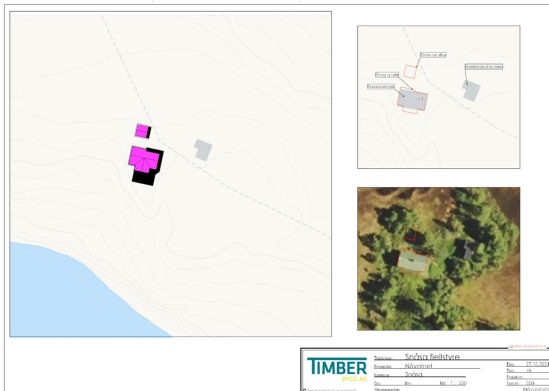
Fig. 2: Situasjonsplan som viser plassering av hytte og uthus som skal rives og plassering av ny hytte og nytt uthus i forhold til dagens – Nåvasshytta Åsvatnet 1 i Snåsa kommune.
