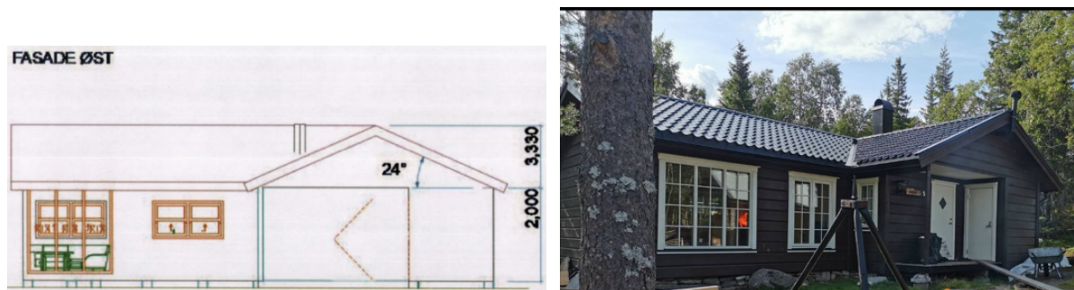
Figur 4: Fasade øst i original byggetegning er vist til venstre. Til høyre er fasade øst på ferdigstilt bygg.
