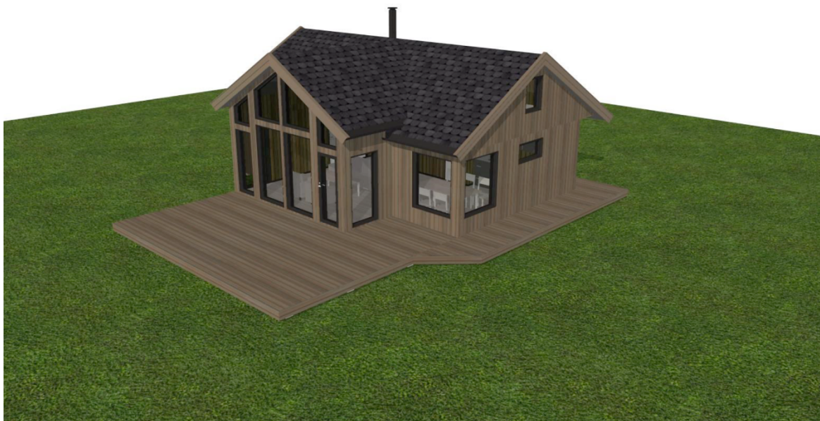
Fig. 4: Perspektivtegning som viser plattingen rundt ny hytte Nåvasshytta Åsvatnet 1 i Snåsa kommune
