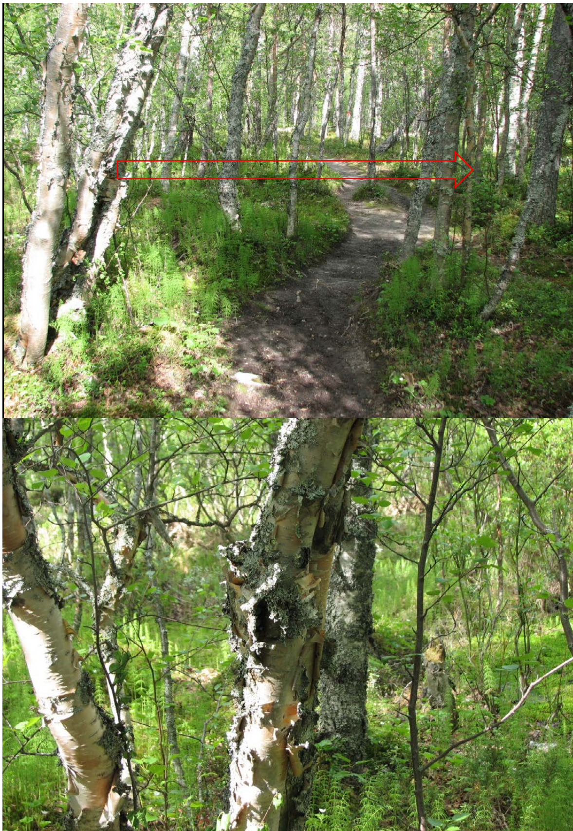
Figur 4. Prinsippfoto av ferdselsteller montert på trestamme og sensorene som peker vinkelrett over stien. Sensoren er i dette tilfelle skjult med never. Foto: Vegard Gundersen
