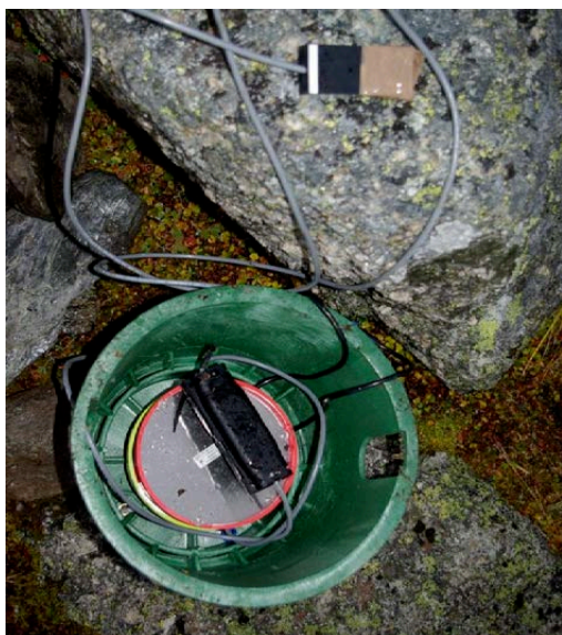
Figur 3. Ecocounter combo teller med telleverk, GSM modem, batteri og sensor. Foto: Vegard Gundersen
