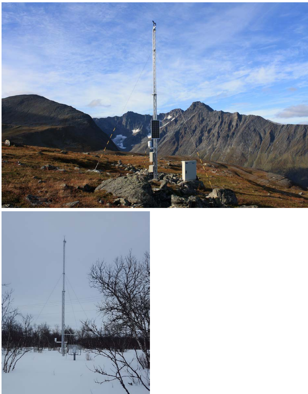
Figur 3.8.4. Ny infrastruktur (base og referansestasjoner) i COATs klimaobservasjonssystem . A) Automatisk værstasjon med gittermast. B) Automatisk værstasjon med gittermast og Geonor nedbørmåler
